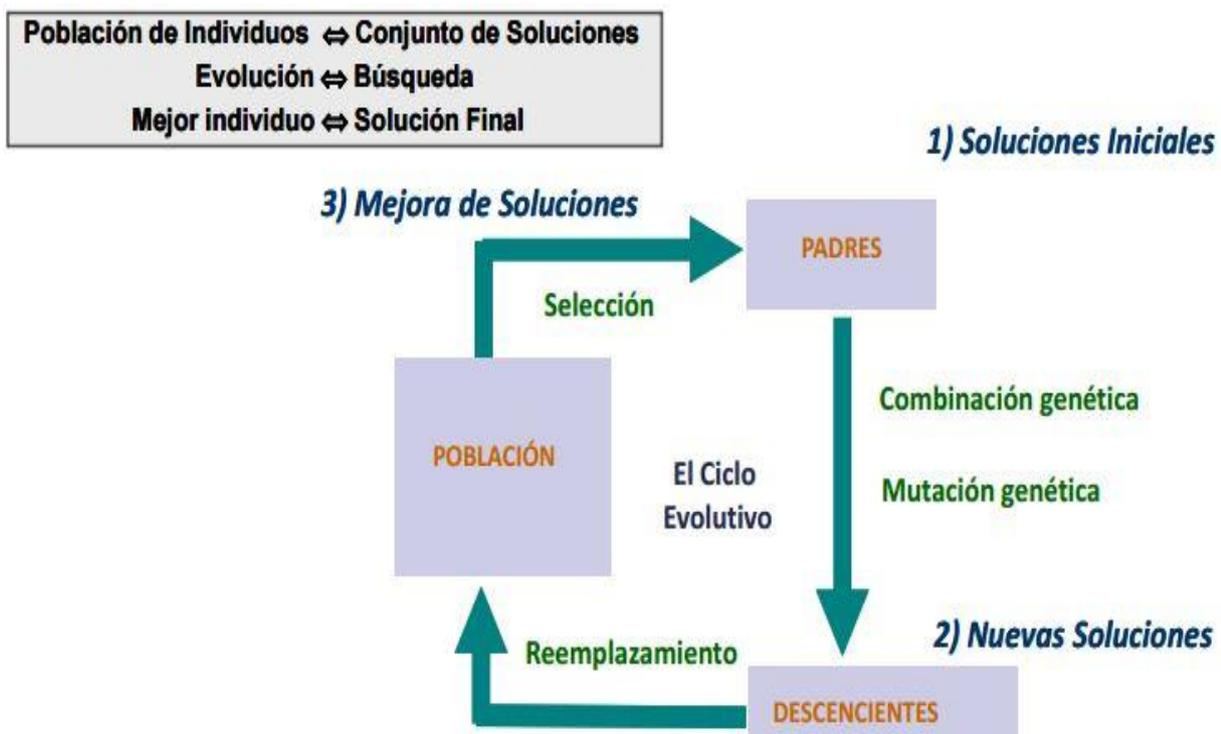
Figura 1. Estructura de un algoritmo genético.
