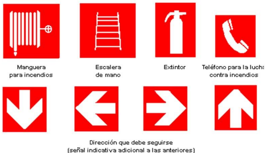
Ilustración 49. Señales relativas a la lucha contra incendios
