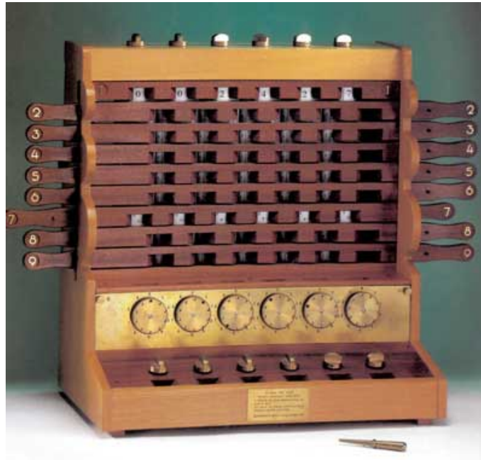
Figura 2.10: Reconstrucción del reloj calculante por el barón Bruno Von Freytag-Löringhoff
