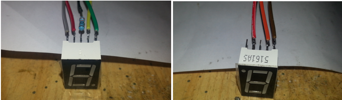
Figura 5.11: Montaje completo del visualizador de siete segmentos, patas superiores (izquierda) e inferiores (derecha)
