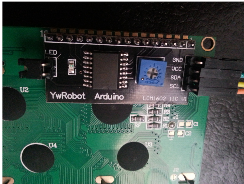
Figura 5.7: Montaje del visualizador LCD
