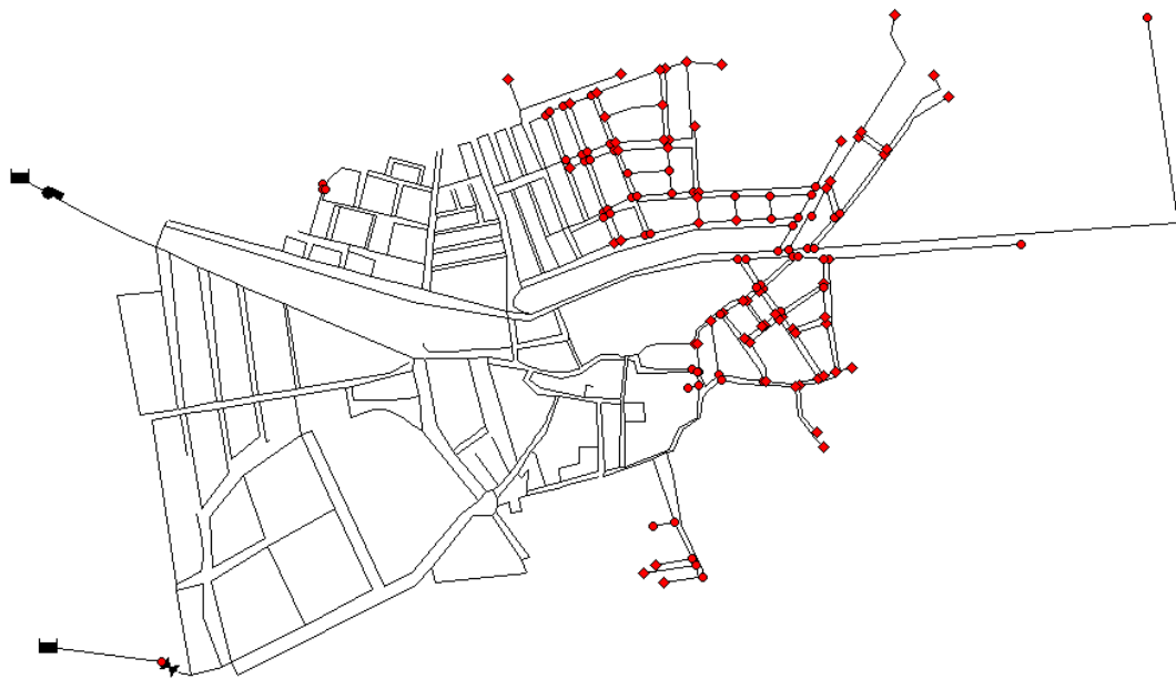
Ilustración 5-III. Nudos con presiones superiores a 7 kg/m 2 . Fuente: elaboración propia.
