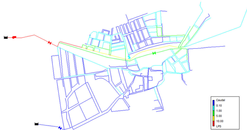
Ilustración 7-IV- Distribución de caudales en la red sectorizada Muro de Alcoy a las 04:00 am. Fuente: elaboración propia.
