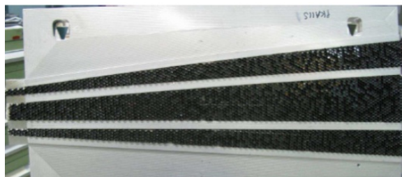
Figura 2. Imagen del Honeycomb y las placas de aluminio posicionadas.
