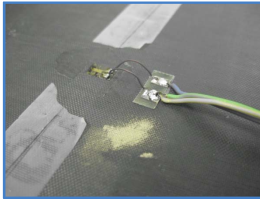
Figura 19. Galga sobre el substrato en dirección longitudinal.
