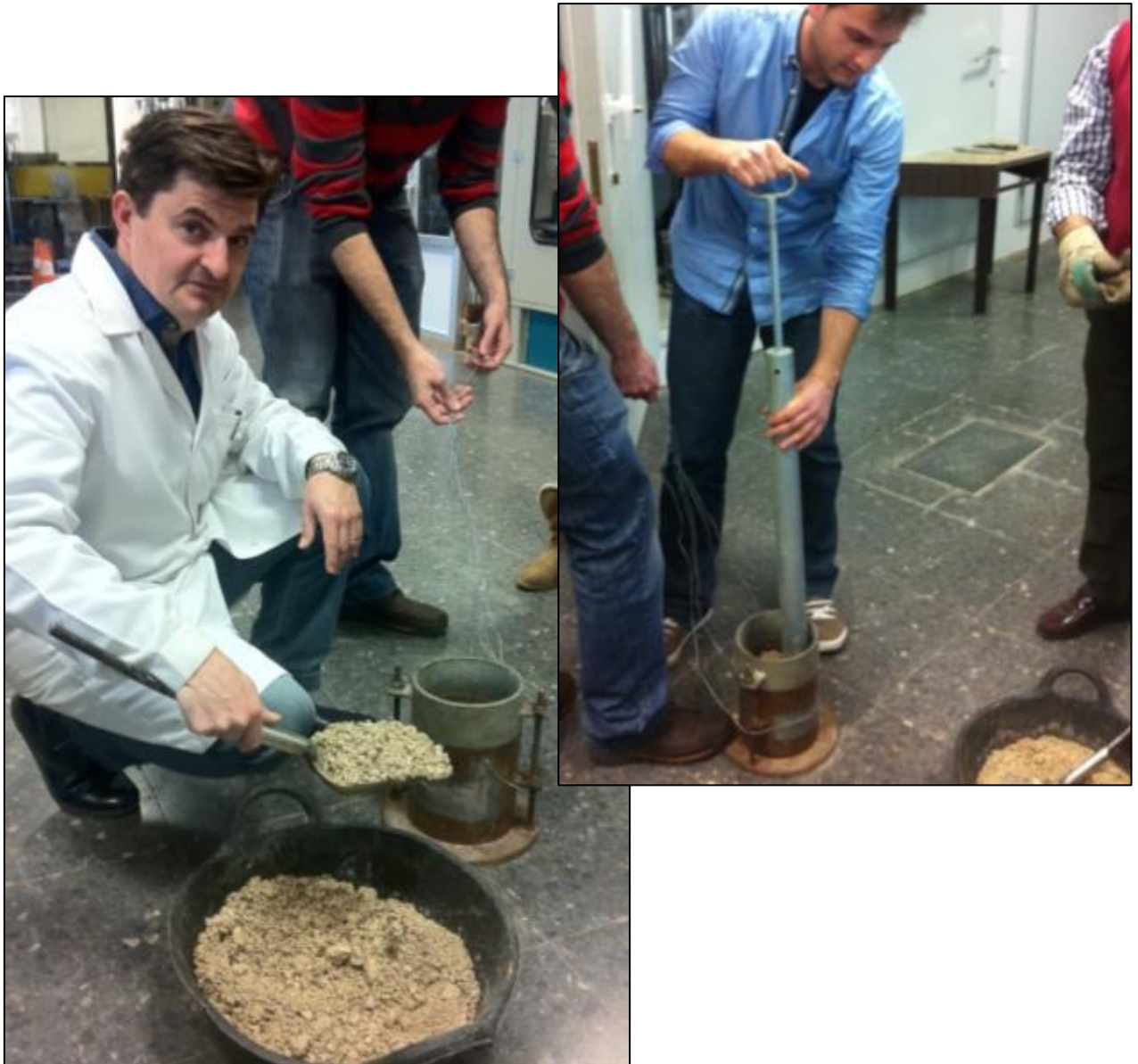
Ilustración 20. Proceso de llenado y compactado de la muestra.
