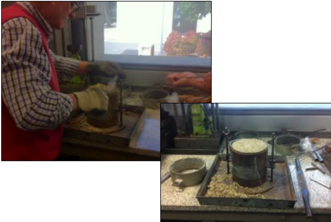
Ilustración 21. Proceso de enrasado de la muestra.
