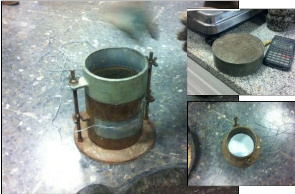
Ilustración 18. En el se puede observar la probeta CBR con el collar en su parte superior. En la parte superior derecha se observa el disco espaciador y en la inferior el papel de filtro con el conjunto montado.
