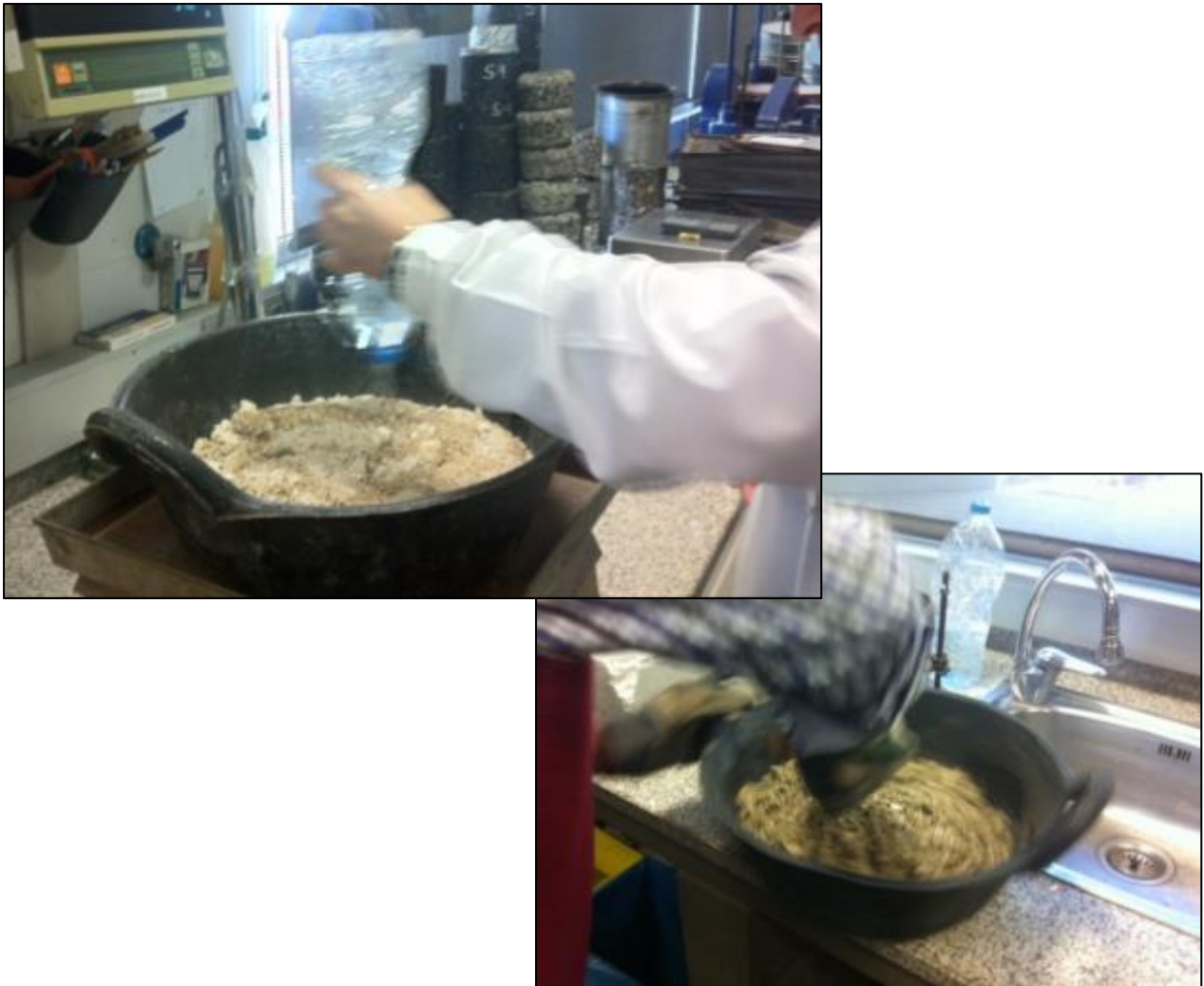
Ilustración 19. Vista del proceso de adición de agua y amasado.
