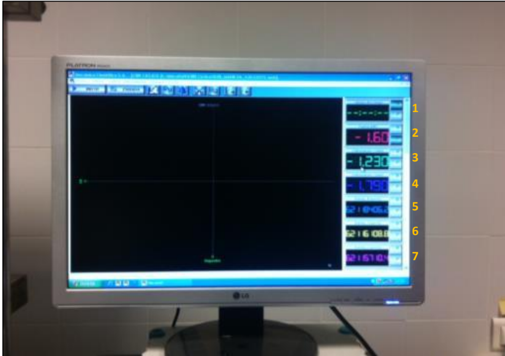
Ilustración 27. Detalle del software de representación de los datos. Donde: 1 corresponde al cronómetro del ensayo, 2 fuerza en kN, 3 y 4 lecturas de deformación y 5, 6 y 7 medición de las tensiones de las bandas extensiométricas.
