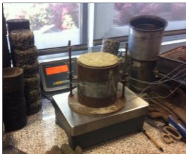
Ilustración 22. Pesaje del molde tras el proceso de compactación.
