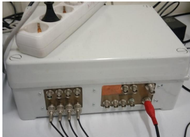
Figura 7 Multiplexador para la excitación y recepción de la señal de ultrasonidos.
