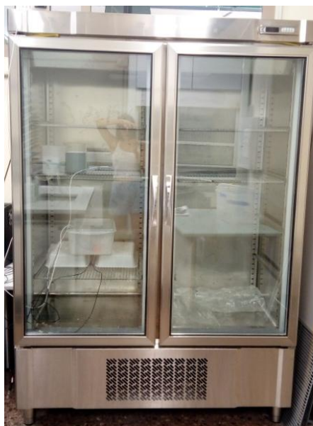
Figura 5 Cámara frigorífica para el salado de los lomos a temperatura controlada.
