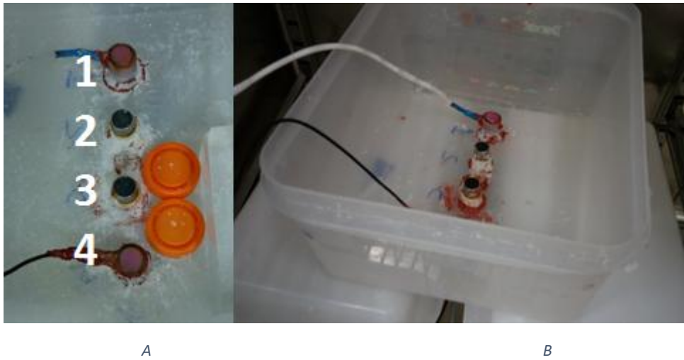
Figura 3 Sistema para la monitorización del salado de lomo mediante ultrasonidos. (A) Detalle de los transductores. (B) Cubeta de plástico con los transductores.
