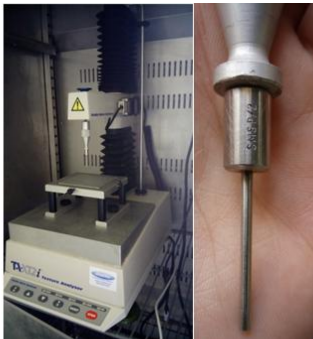
Figura 15 (A) Equipo medición textura. (B) Detalle punzón.
