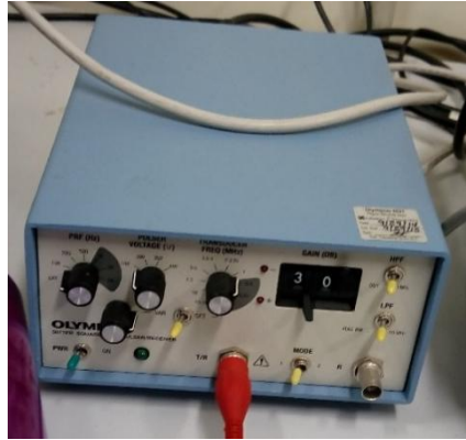
Figura 6 Generador-receptor empleado para la monitorización del salado y post-salado de lomos.
