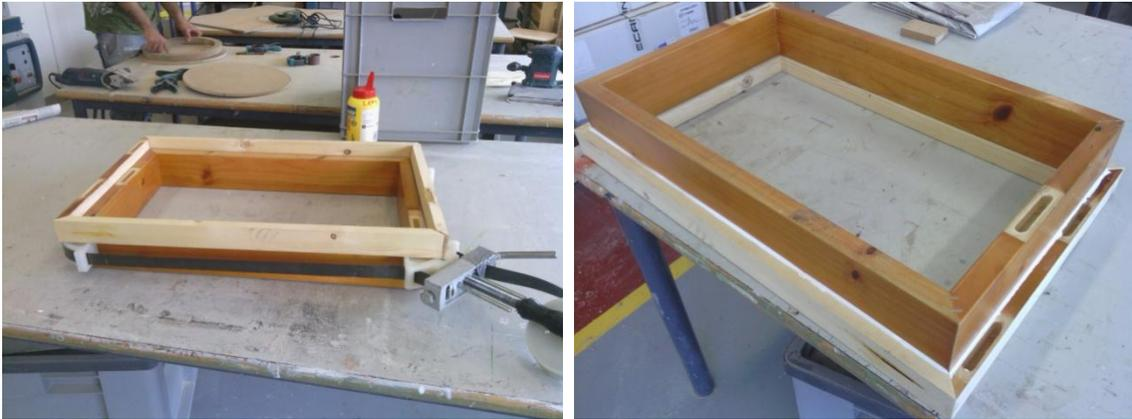
Fig. 24 y fig. 25. Fotos tomadas en el taller durante la fabricación del alza.
