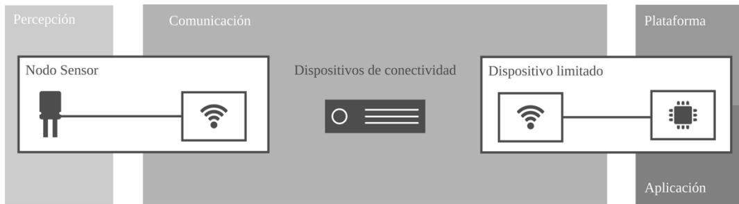
Figura 57 - Arquitectura de SN con dispositivo limitado
