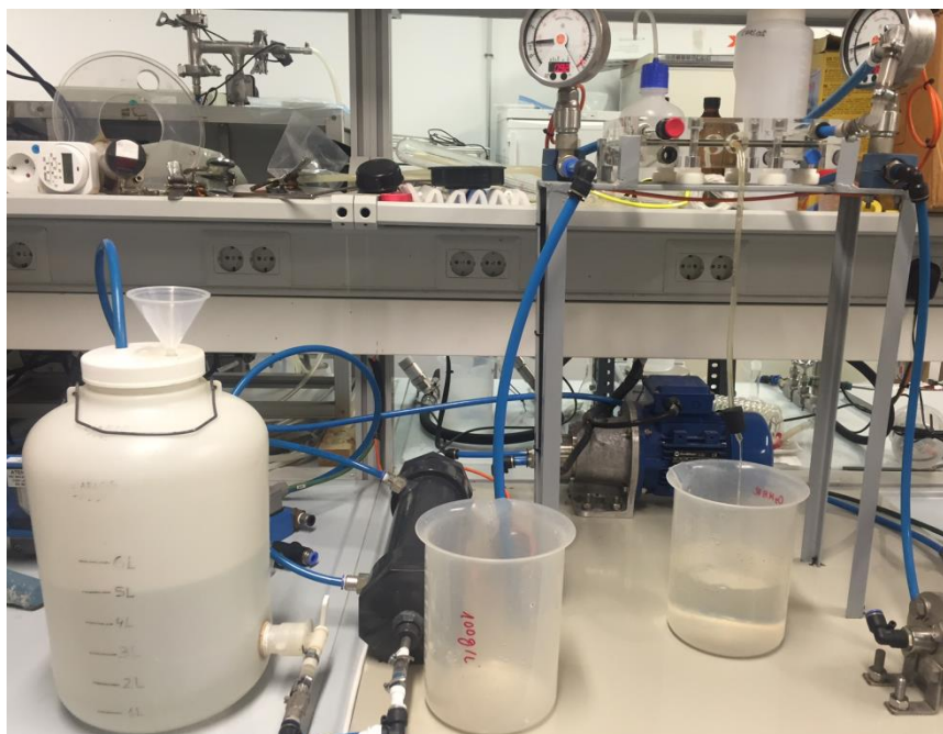
Figura 4.36: Limpieza de planta piloto con agua osmotizada y recirculación.
