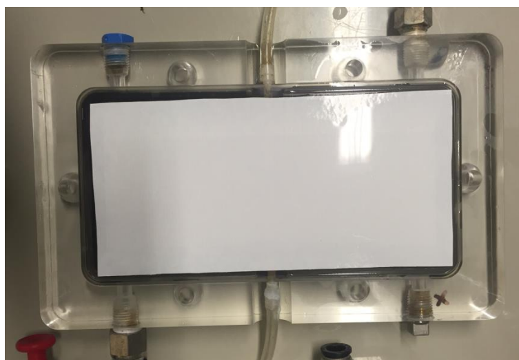
Figura 4.38. Membrana de ultrafiltración introducida en módulo Rayflow 100.
