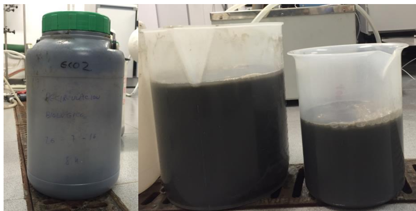
Figura 4.48. Fango activo utilizado en ensayo de resistencia a la filtración.
