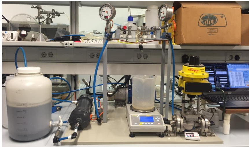
Figura 4.49. Ensayo de resistencia a la filtración con fango activo.
