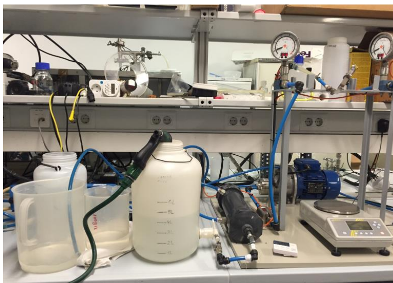
Figura 4.45. Limpieza de la planta piloto con agua de red.
