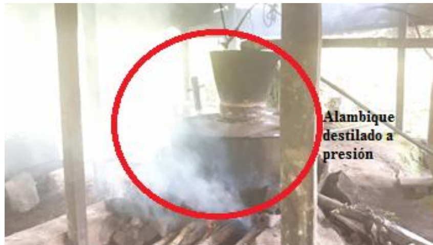
Figura 50. Alambique destilando a presión. Fuente: Mario Paguay García.
