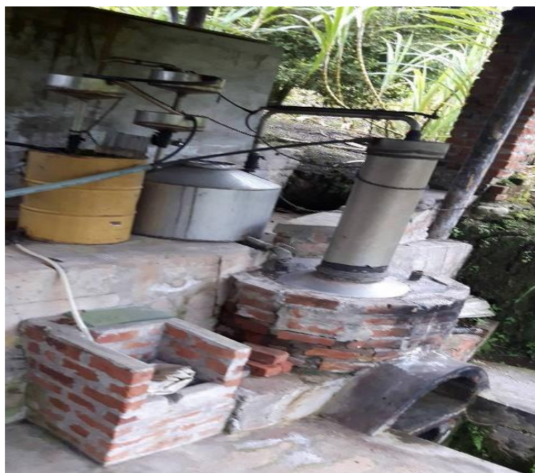
Figura 20. Caldero para destilar alcohol de caña de azúcar. Fuente: Mario paguay García.
