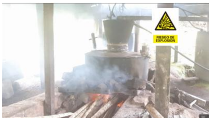
Figura 57. Señalética con peligro de explosiones.
