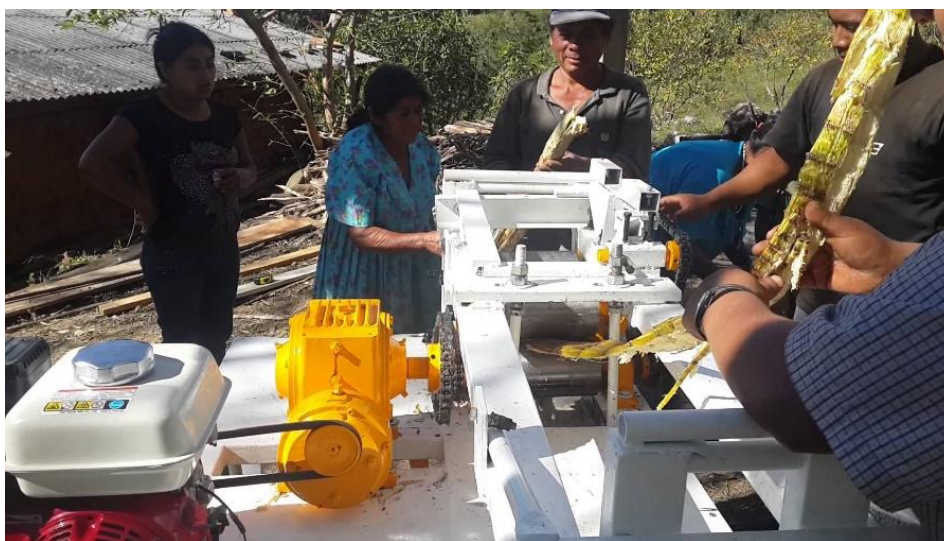
Figura 17. Trapiche impulsado por motor a combustión interna. Fuente: Felo Montoya, Trapiche guarapera.
