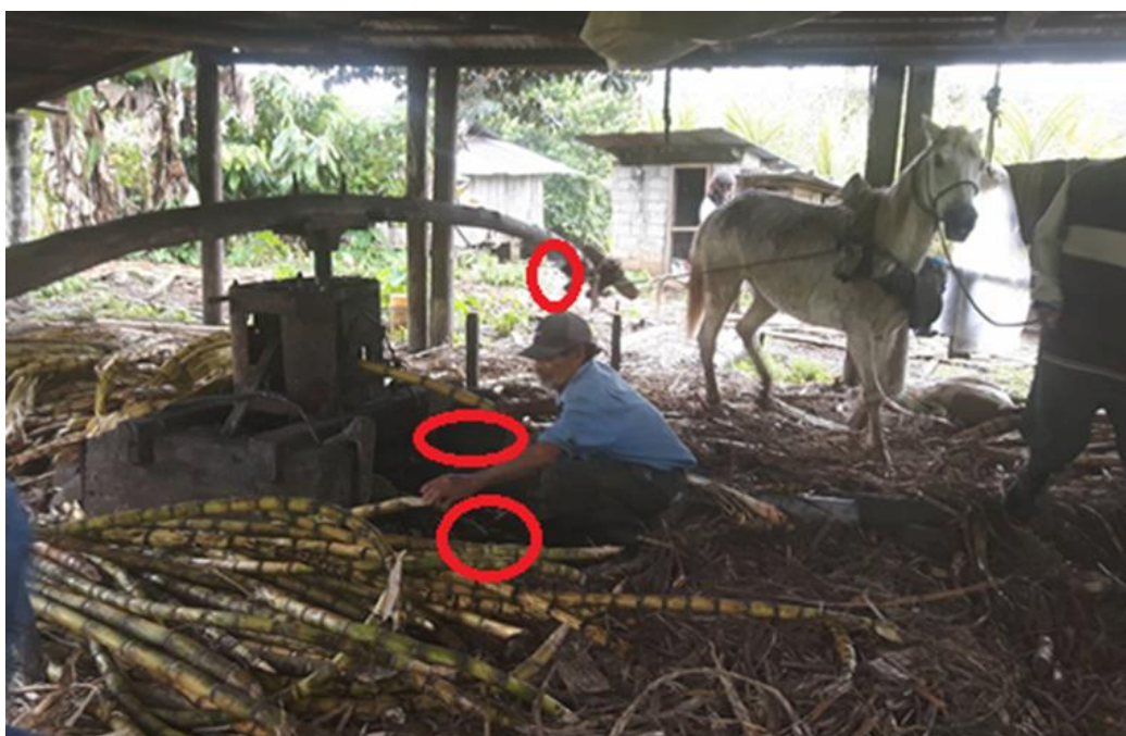
Figura 39. Espacio reducido entre el trapiche, tallos de caña y el yugo. Fuente: Mario Paguay G.
