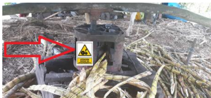
Figura 55. Señalética de peligro de atrapamientos. Fuente: Mario Paguay García.
