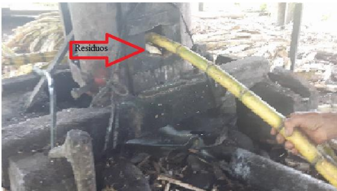
Figura 37. Peligros en el trapiche por residuos que impiden su normal funcionamiento. Fuente: Mario Paguay G.
