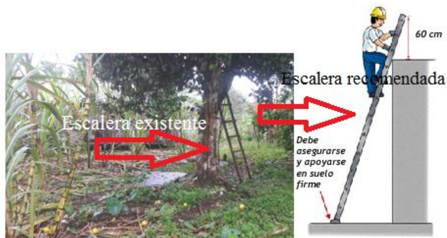
Figura 60. Escalera con características técnicas adecuadas.
