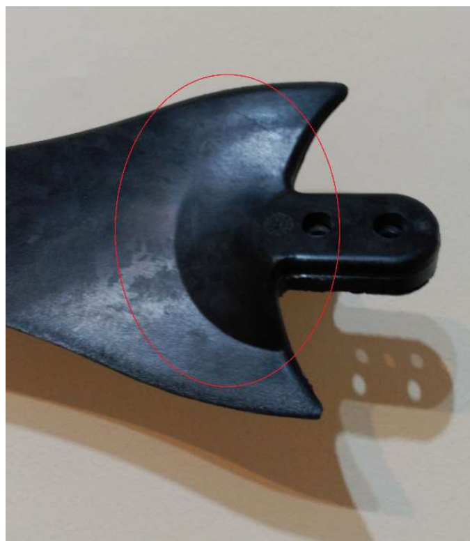
Figura 53.- Rectificado entre la raíz y la zona aerodinámica de la pala del Air X Land.
