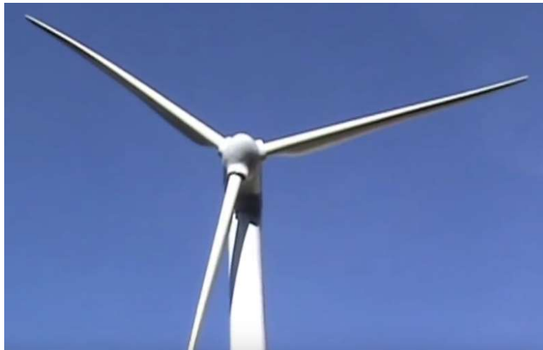
Figura 26.- Posición bandera de las palas de paso variable.
