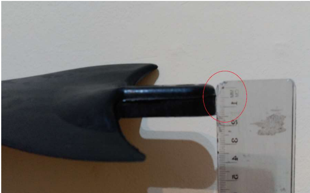
Figura 52.- Grosor de la raíz de la pala del aerogenerador Air X Land.
