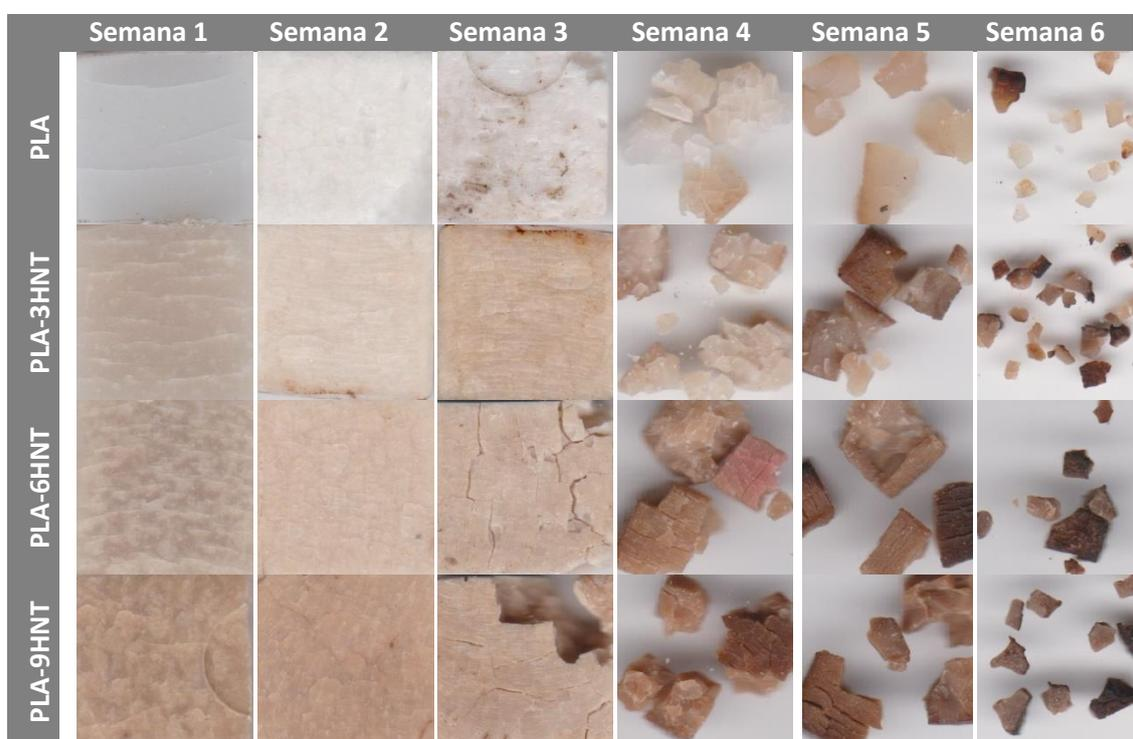
Ilustración 27. Aspecto macroscópico de las diversas etapas de degradación de los compuestos PLA-HNT, y del PLA puro, a distintos tiempos de enterramiento.
