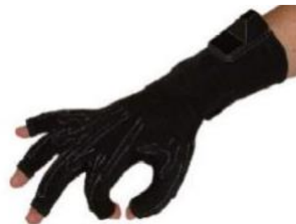
Fig.6 DataGlove VRLOGIC con sensores flexibles [43]
