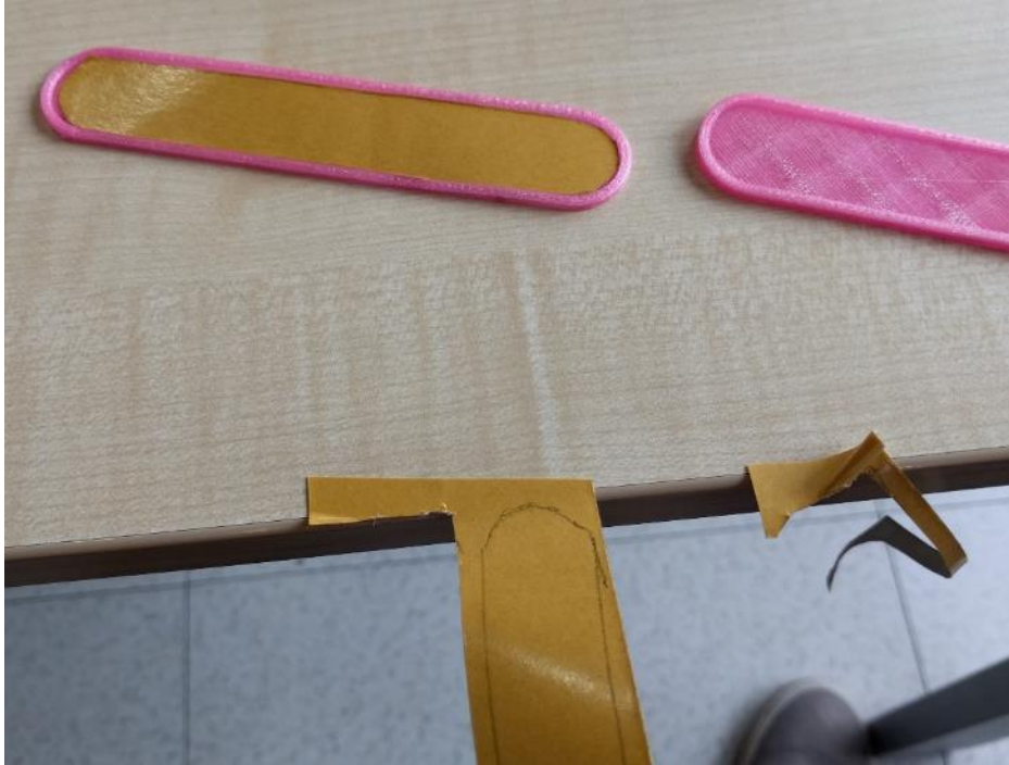
Fig.109. Soporte de goma flexible para electrodos fabricados mediante impresión 3D.
