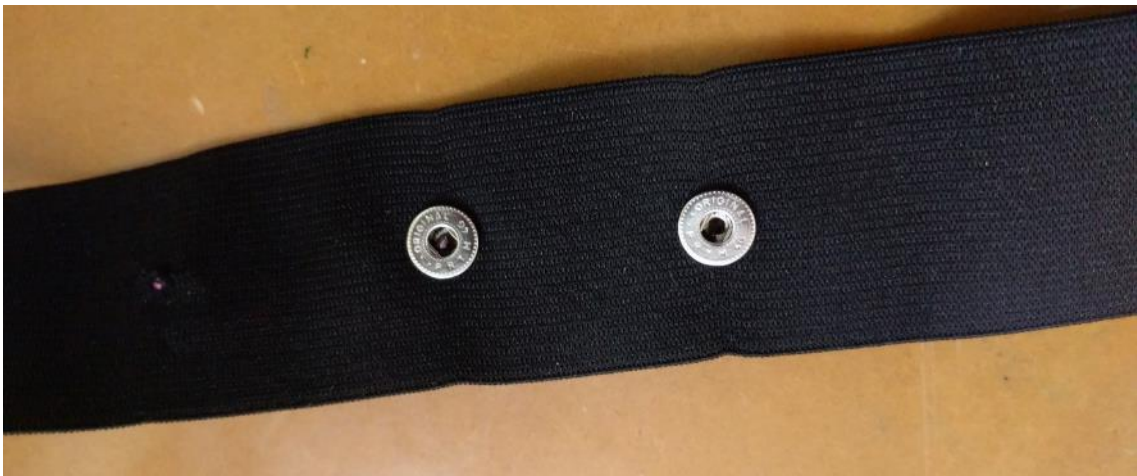
Fig.112. Conectores para electrónica en cara exterior de la cinta
