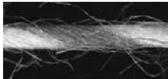
Fig.24 Multifilamentos de metal torcidos junto a hilo [45]
