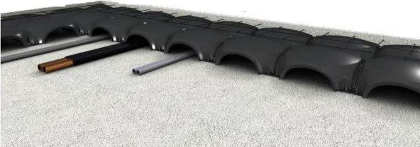
Figura 132. Imágenes y detalle modelado 3D del forjado sanitario “Cávit” junio 2016 Alquería. Figuras propias 2016.
