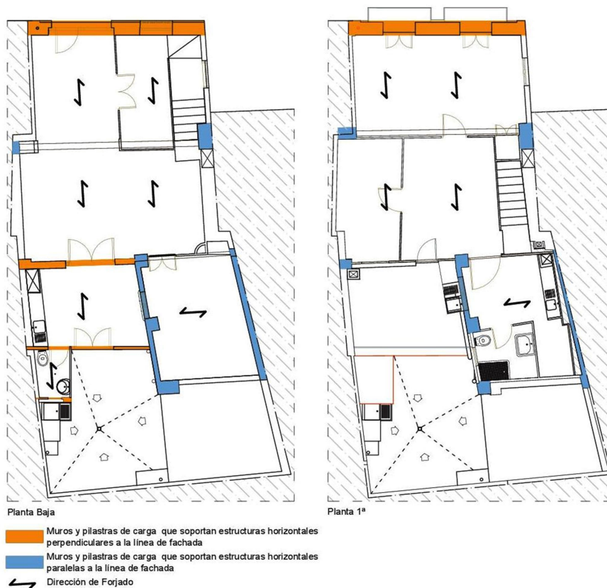
Ilustración 22. Planos en planta del Funcionamiento Estructural Vertical
