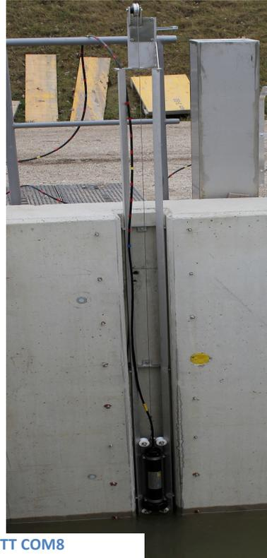
Imagen 8. Detalles soporte sonda SLD OTT COM8
