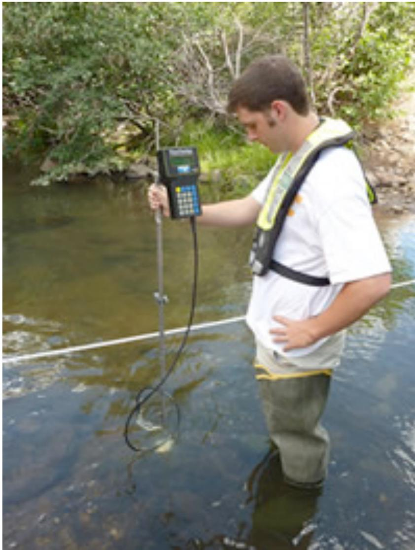
Imagen 12. Utilización de equipo FlowTracker en un cauce de río ("Nevada Water Science Center")
