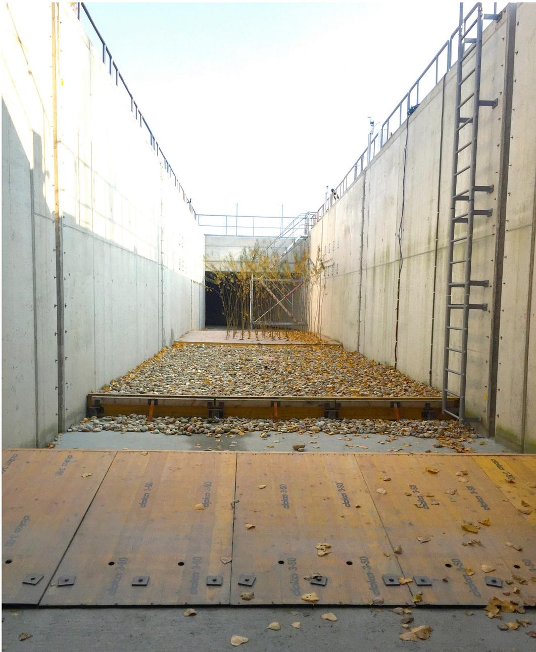
Imagen 13. Lecho de grava. Punto de medición con la sonda FlowTracker.
