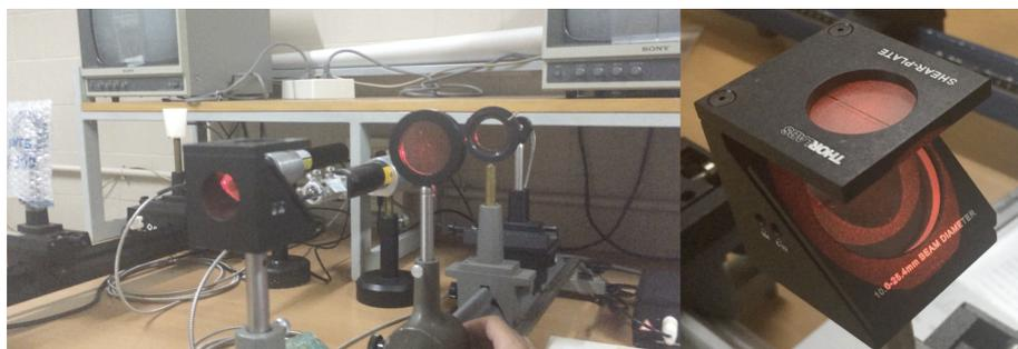
Fig. 42. Interferómetro y emisor de láser. Laboratorio de Óptica Facultad de Físicas UV.
