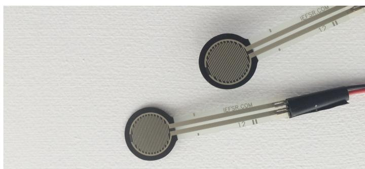
Fig. 45. Sensores de presión FSR 402 de 14,7 mm. de diámetro
