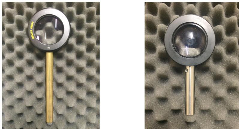
Fig. 33. Lentes con focal f200 mm y f100 mm con montura de 1,2 cm
