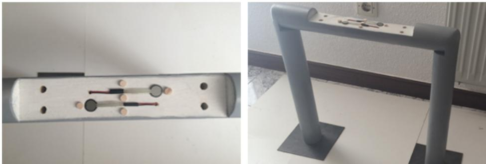
Fig. 56. Dispositivo-asiento para el usuario con sensores FSR (sin la tapa a la izda.).
