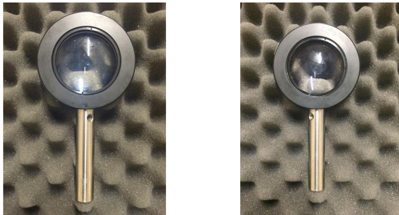
Fig. 32. Lentes con focal f200 mm y f80 mm. Ambas con montura de 1,2 cm.
