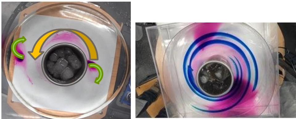
**Figura 16.** Izquierda: el flujo inferior (flechas verdes) gira en sentido contrario al giro del tanque (flecha naranja). Derecha: formación de los anillos de fluido que se mueven ciclónicamente hacia el centro.
