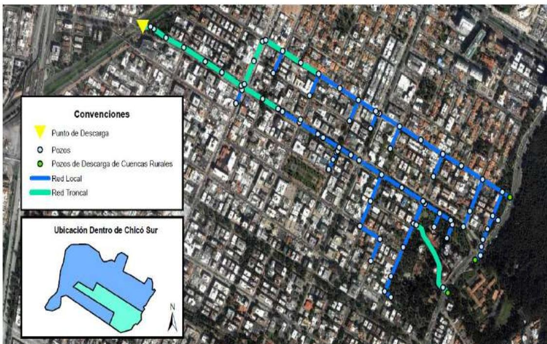
**Figura 17. Esquema de la red de drenaje E-Chicó (señalización de los tramos de red local y troncal) y ubicación de la misma dentro de Chicó Sur.**
