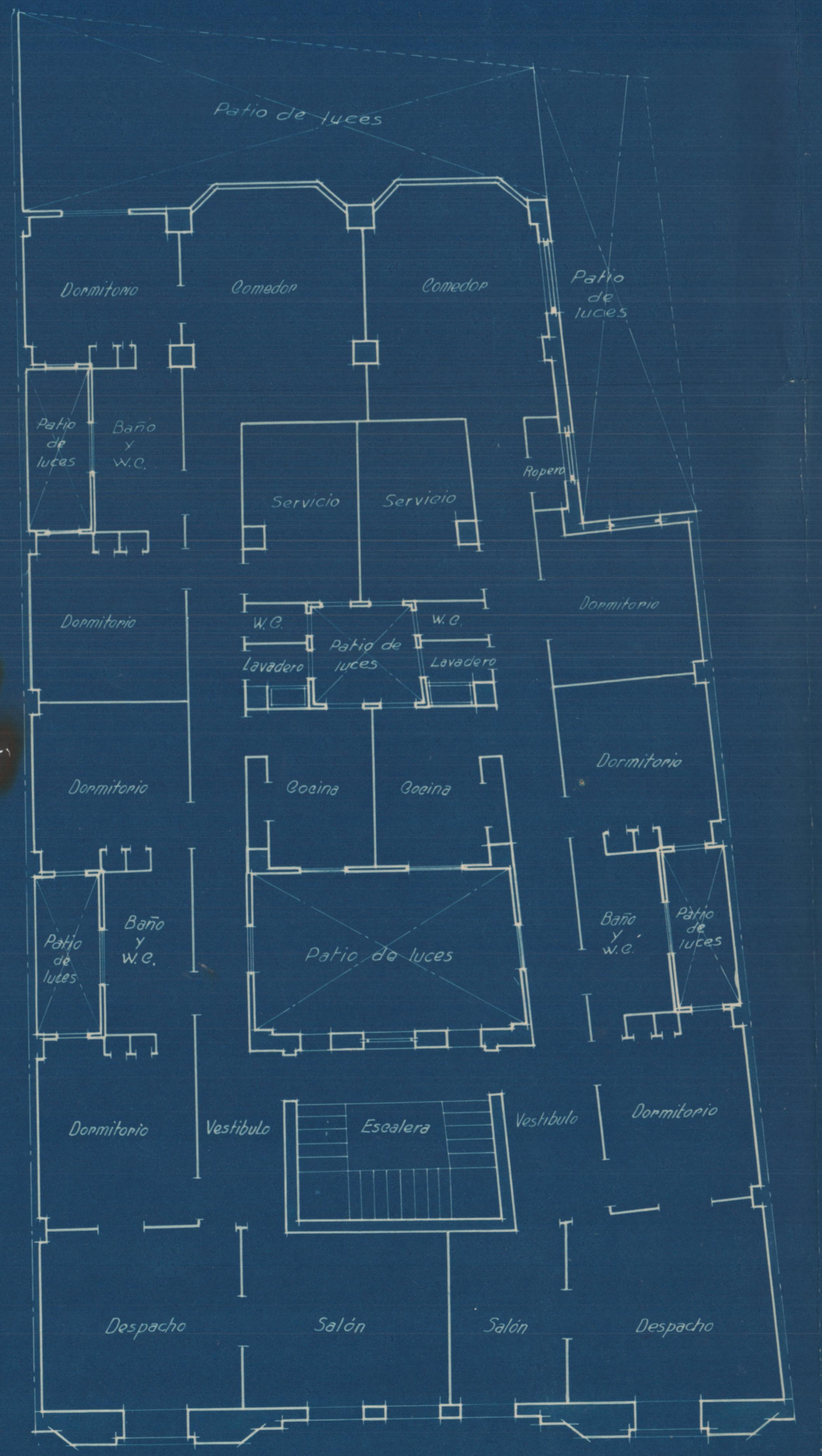
Planta común a pisos
