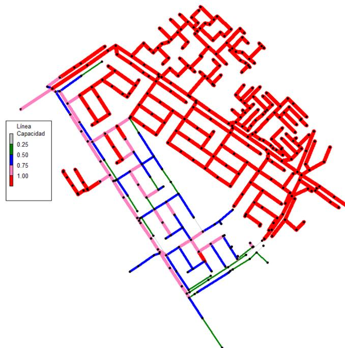
Figura 30. Capacidad conductos. T=Climático
