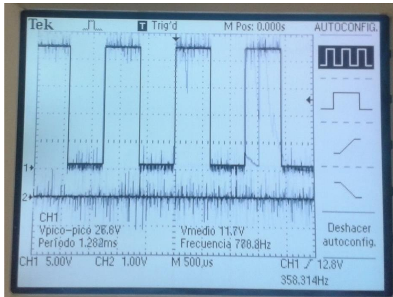
0.26 Ruido observado en la señal del encoder
