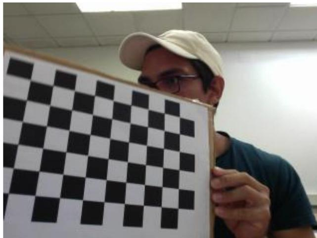
Figura 17 Chessboard utilizado para la calibrar de la cámara
