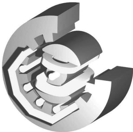
Fig. I-18 Circuito magnético principal de una máquina síncrona bipolar
