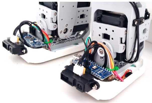
Figura 24. Nueva planta del pie montada en el robot Bioloid
