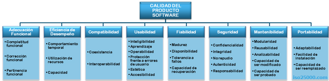
Figura 3.1. Modelo de calidad del producto software ISO 25010 (ISO/IEC, 2011)
