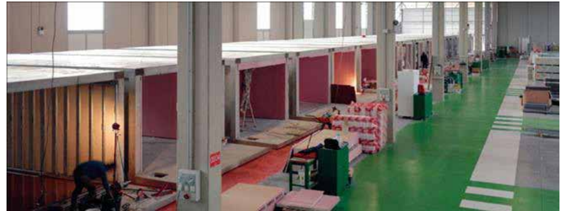
Gráfico 77: Industrialización de un módulo de vivienda Fuente: http://territori.gencat.cat/ca/detalls/Article/INCASOL-El-sistema-eMli-de-Compact-Habit-la-fabricacio-en-serie-arriba-a-la-construccio
