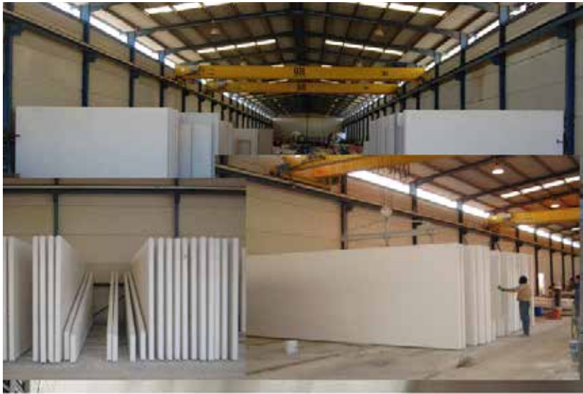
Gráfico 90: Acopio de paneles de hormigón armado Fuente: http://cordoba.placasalveolares.com/
