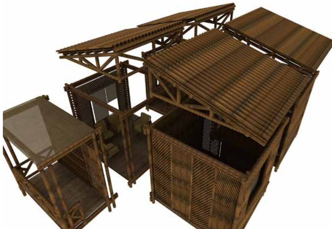
Gráfico 376: Perspectiva de ensamblaje de módulo Fuente: Proyecto normativo, diseño y construcción con bambú
