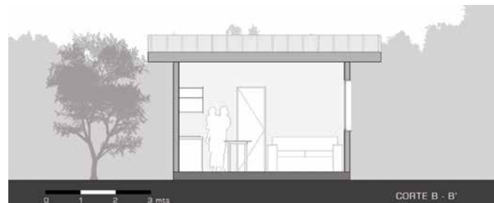
Gráfico 240: Corte de vivienda rural FNH Fuente: http://www.archdaily.pe/pe/02-109626/vivienda-social-rural-fnh-equipos-pontificia-universidad-catolica-de-chile/512ba458b3fc4b11a700bfe2-vivienda-social-rural-fnh-equipos-pontificia-universidad-catolica-de-chile-imagen
