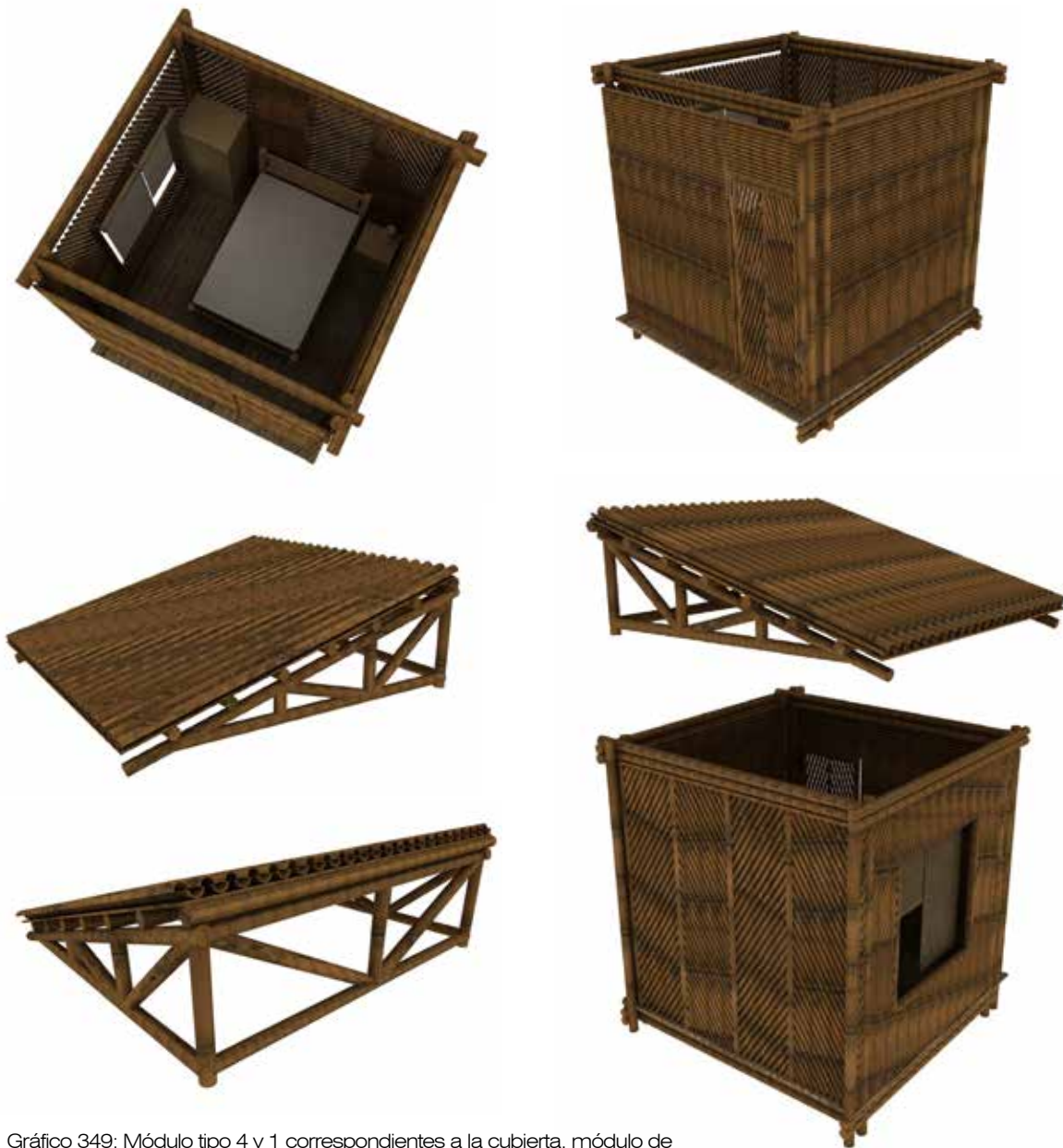
Gráfico 349: Módulo tipo 4 y 1 correspondientes a la cubierta, módulo de habitación y anclaje de los dos módulos Fuente: Autora
