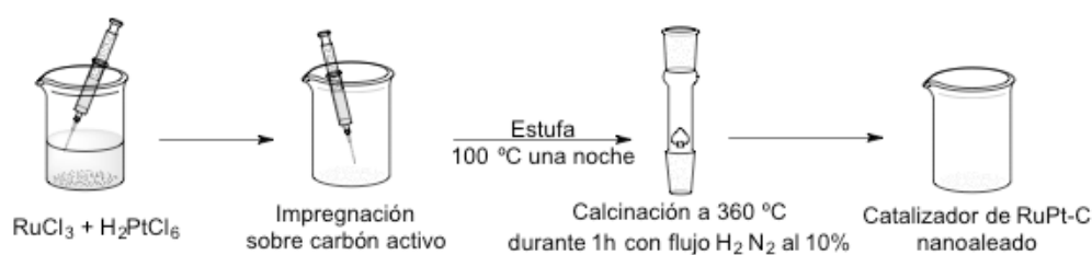
Esquema 6. Preparación del catalizador de RuPt/C nanoaleado.
