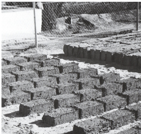
Fig. 35 Técnica dels gassons ( Tesis doctoral, Pastor Villa, p. 205 )
