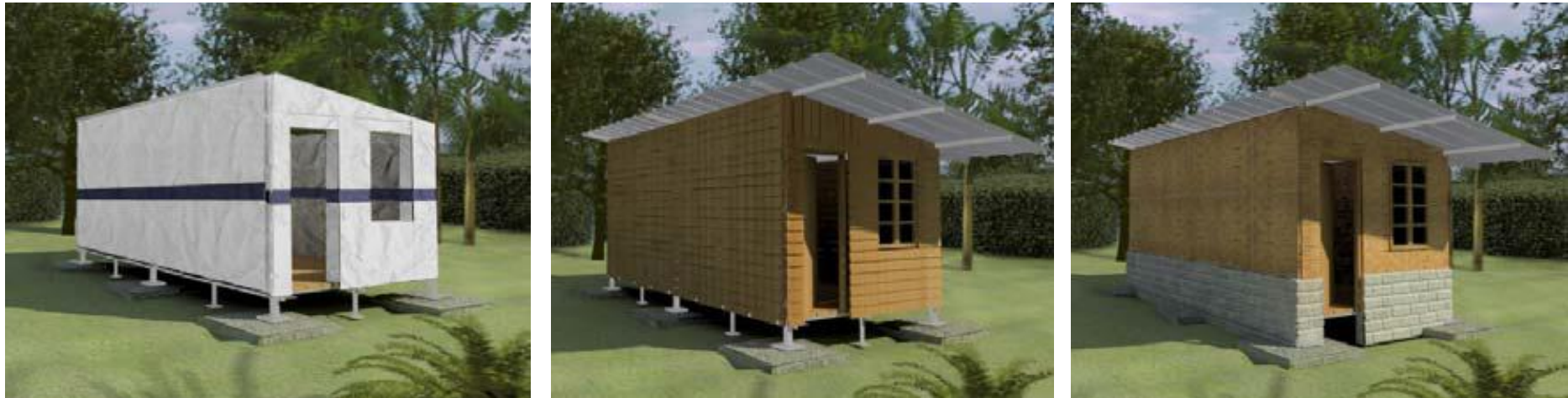
Ilustración 34: Imágenes ilustrativas del proceso evolutivo de las APT en términos de permanencia del primer prototipo.
