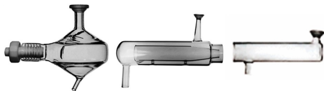
Figura 4.23: Cámara de nebulización ciclónica (izq.), tipo concéntrica de paso doble (centro) y tipo concéntrica de paso simple (der.)
