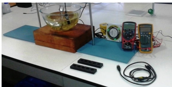
Figura 5.8: Banco de ensayos de caracterización del sensor Gill.
