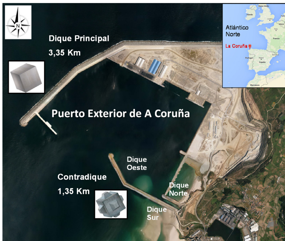
Figura 1. Planta del puerto exterior de A Coruña en Punta Langosteira (15/09/2015). Fuente: autoridad portuaria de A Coruña y datos del mapa ©2016 Google, INEGI, ORION-ME.
