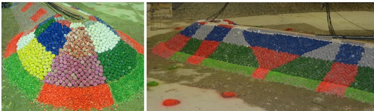
Figura 9. Modelo I «morro», vista del morro bicapa y de la transición monocapa-bicapa de cubípodos de 24 t. Fuente: GEAMA (UDC).
