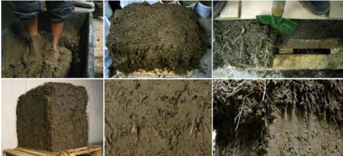
Imagen 14. En la imagen podemos ver el proceso de conformado de la pasta para realizar mampostería de Cob. La paja es el material necesario para mantener la cohesión del conjunto.
