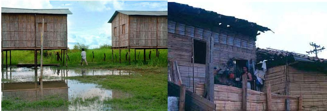
Imagen 34. Utilización del bambú por gente de escasos recursos en zonas rurales de Colombia. El material es utilizado en varios elementos que componen la obra, estructura, cubierta, fachada.
