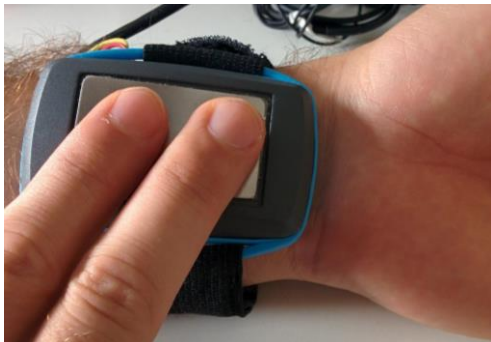
Figura 5b. Medida de ECG y pulso en la cara interior de la muñeca
