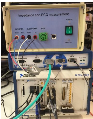
Figura 4. Montaje detallado. De arriba abajo: Front-end para el aislamiento del paciente, Biopac y PXI
