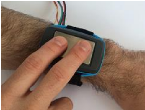
Figura 5a. Medida de ECG y pulso en la cara externa de la muñeca
