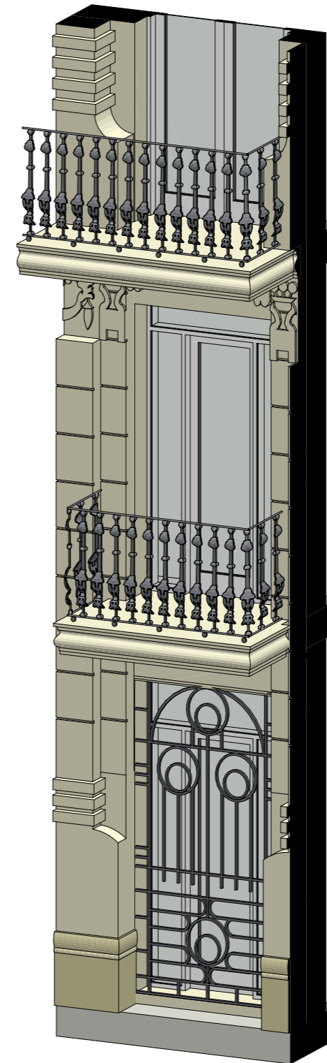
Detalle 3 Acceso Planta Baja 1:50
