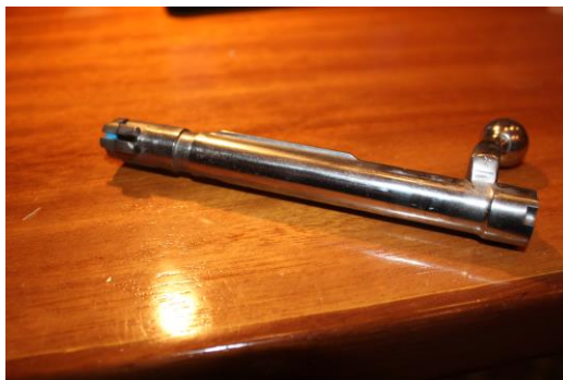
Imagen 4.1. Cerrojo Mauser de acero C45 donde se encuentra la falla.
