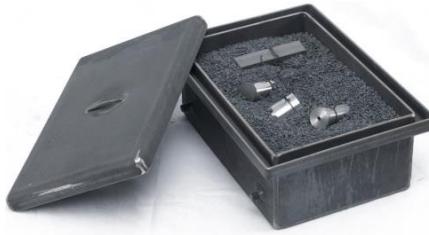
Imagen 3.15. Caja de cementación
