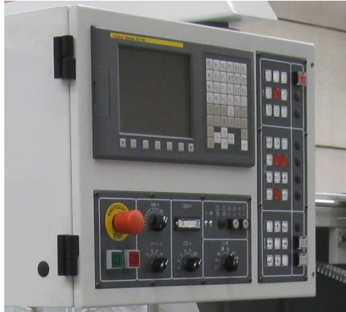
Imagen 7.1. Ordenador de control numérico integrado al torno.
