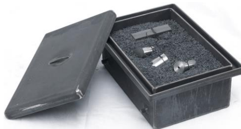
Imagen 5.3. Caja de cementación.
