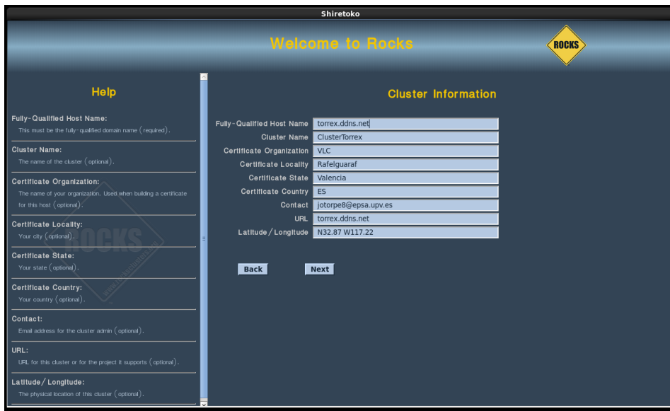
Figura 3.14: Instalación Rocks: Información identificativa del cluster
