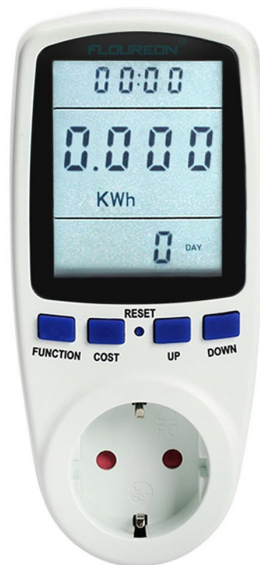
Figura 6.1: Herramienta de medición de consumo eléctrico utilizada: Floureon TS-836A
