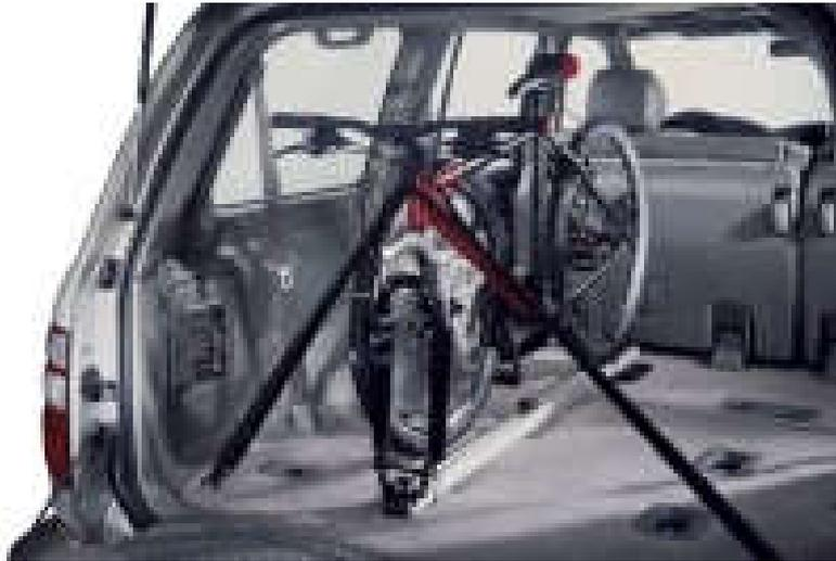
**Figura 1.1.5** Portabicicletas en el interior de un vehículo.
