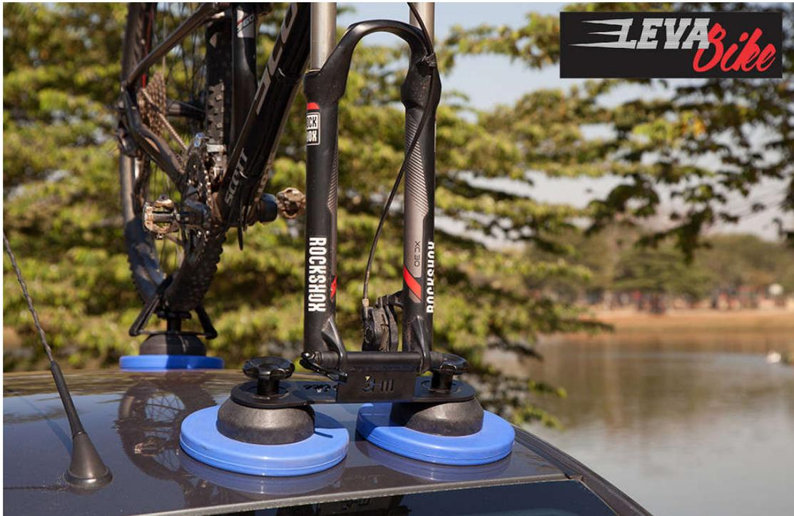
**Figura 1.2.1** Portabicicletas de ventosas con 2 ventosas delanteras.
