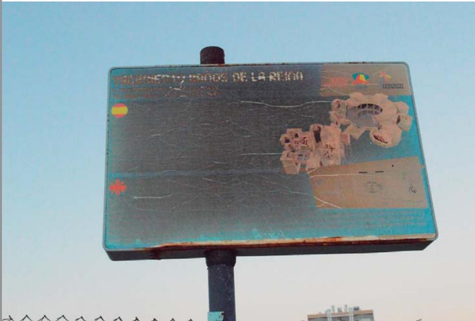
Fig. 40 – Panel interpretativo dañado por la acción de la radiación solar (febrero 2016)
