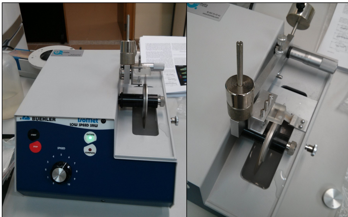
Fig. 6.3. Corte transversal del otolito sagitta efectuado mediante la utilización de una sierra Isomet ©Buehler.
