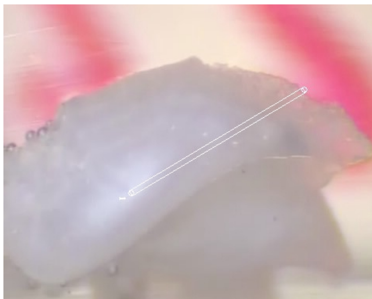
Fig. 6.6. Imagen tomada por el programa asociado al LA-ICP-MS de un corte transversal de otolito sagitta con la transecta de ablación marcada. El sentido de la ablación es de núcleo a borde.
