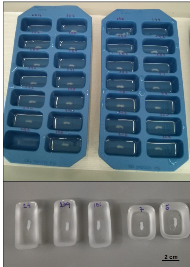
Fig. 6.2. Inclusión de otolitos sagittae en resina epoxi para la realización de secciones transversales.
