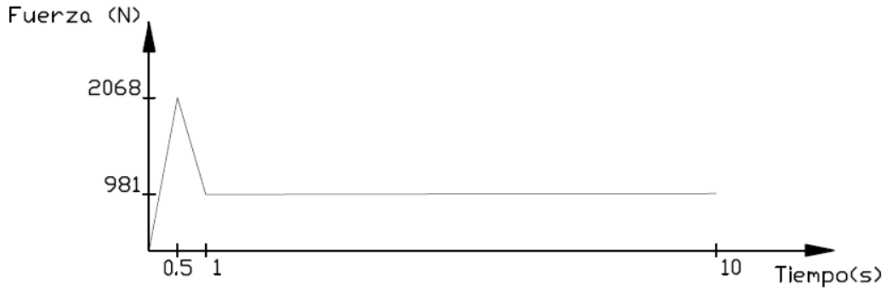
Figura 5-22. Curva Fuerza vs Tiempo, que representa la fuerza aplicada a lo largo del tiempo al marco en el punto 5, ilustrado en la figura 5-20.
