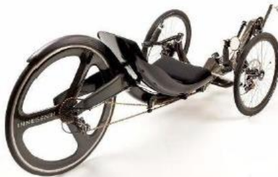
Figura 2-2. Configuración "Tadpole" (2F1R) [1].
