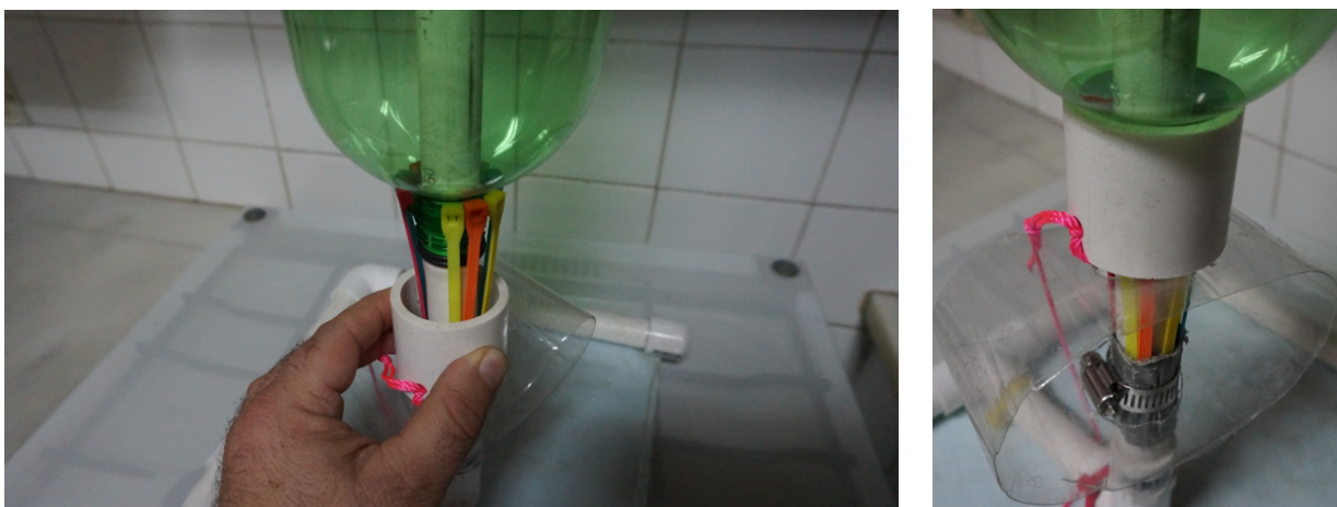
Figura 3: Izquierda:Detalle del sistema de lanzamiento con bridas. Derecha: Sistema de seguridad para evitar la retracción inesperada de las bridas.
