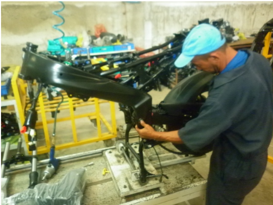
Figura 5. Unión del Chasis con el Oscilante
