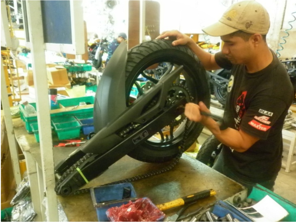
Figura 4. Ensamble de oscilante (parte trasera de la moto)
