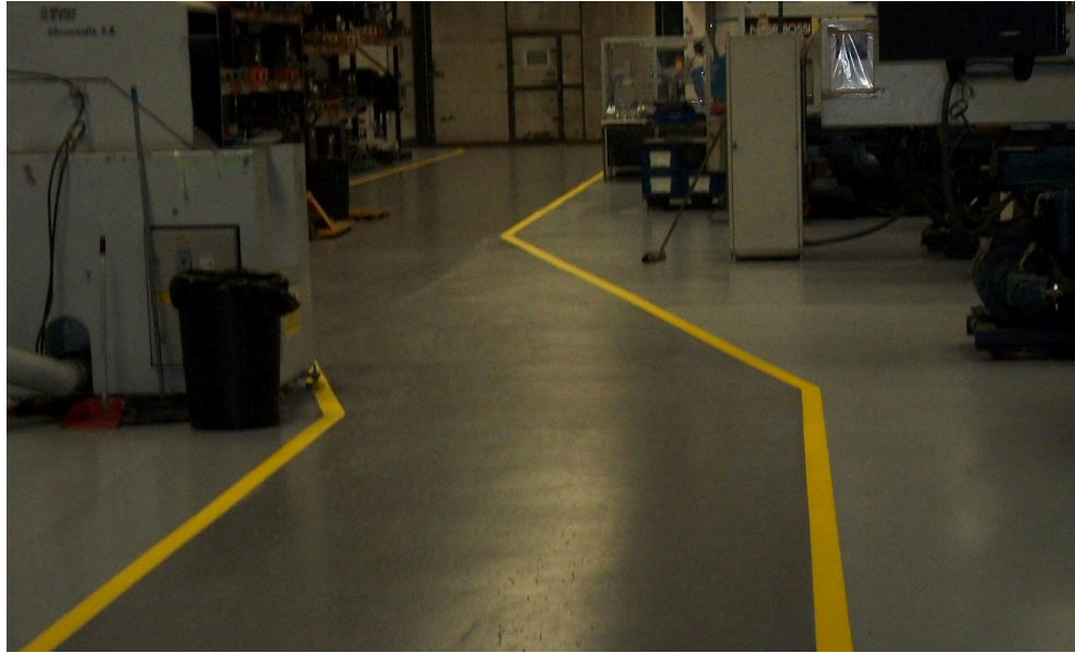
Figura 29. Señalización de zona de tránsito.
