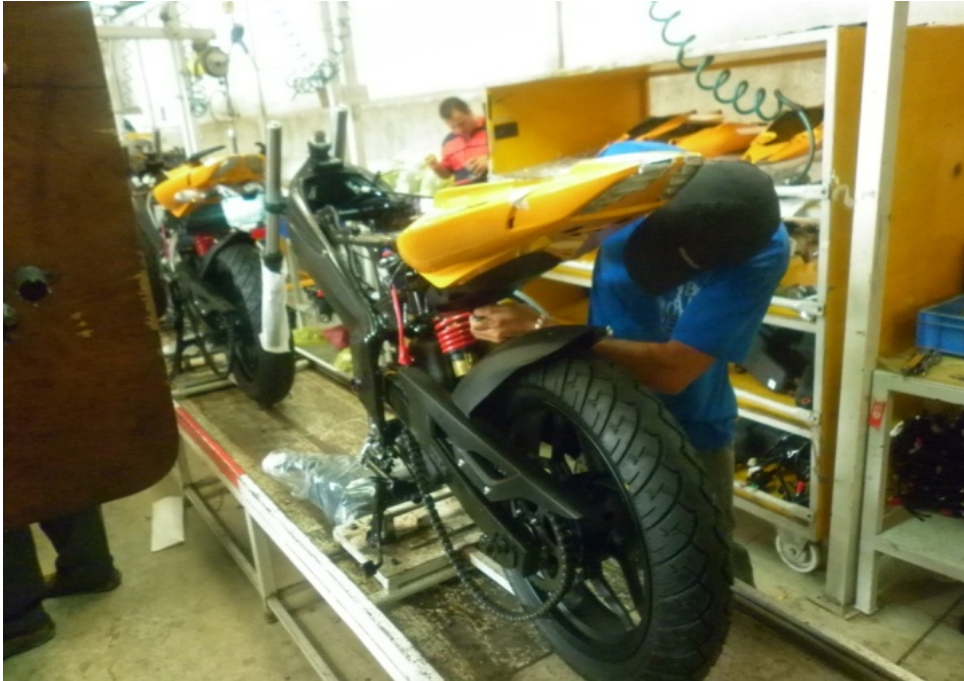
Figura 7. Montaje del Mono shock
