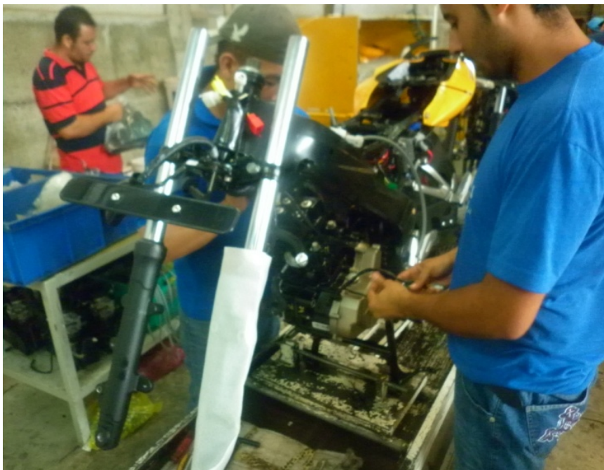
Figura 10. Conexiones eléctricas y de alimentación del motor
