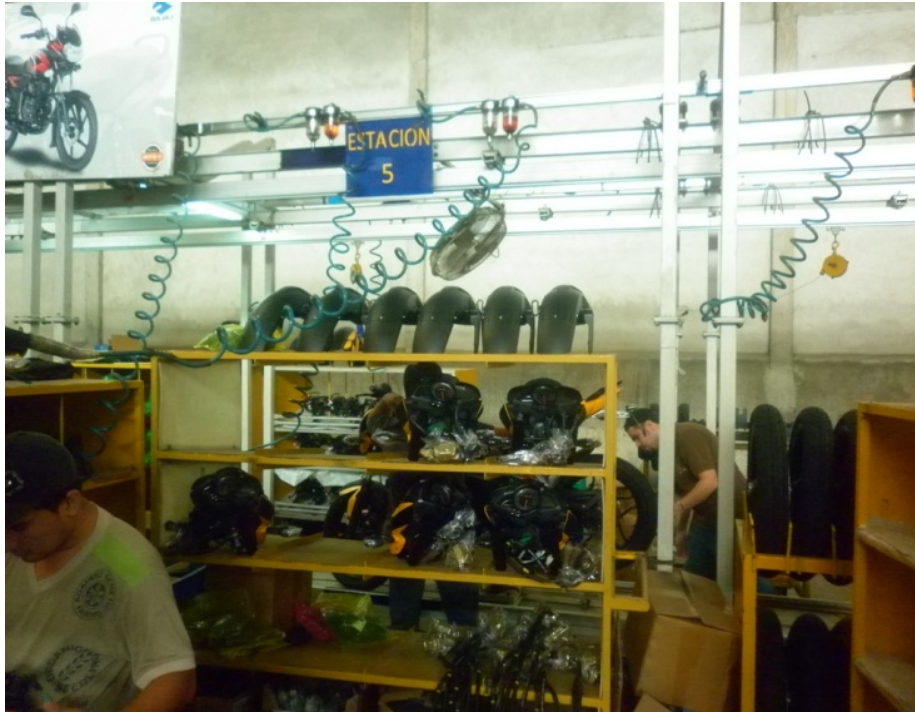
Figura 13. Ensamblaje de la parte frontal de la motocicleta
