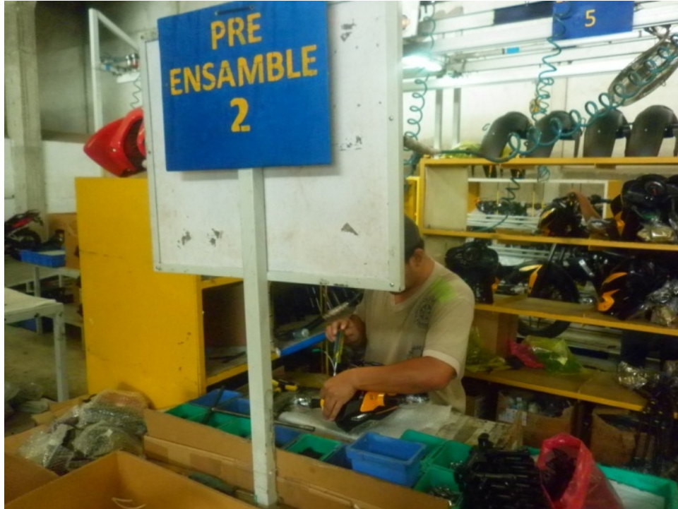
Figura 15. Colocación de tablero de instrumentos
