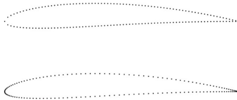
Figura 141.2: Perfil NACA 3510 con discretización lineal (arriba) y con discretización tipo coseno (abajo). 150 paneles.
