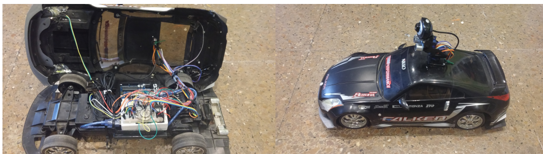
Figura 27: Cableado Interno del coche
