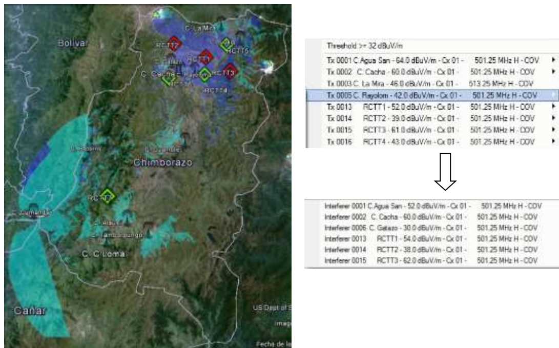
Figura 4.14 Interferencias en canal ascendente causadas por distintos RCTTs hacia la torre de TV “Rayoloma”
