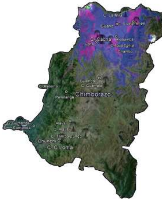
Figura 4.10. Cobertura enlace descendente DVB-T2 para DVB-RCT2, utilizando varias frecuencias y transmitiendo contenido diferente, área de operación 1.
