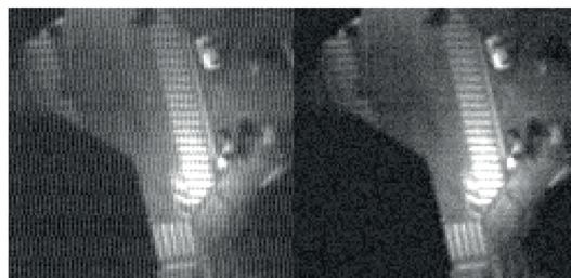
Figura 6. Ejemplo de patrón de ruido electrónico en el canal pancromático para una captura nocturna DMC y de su eliminación con técnicas de filtrado elimina-banda.
