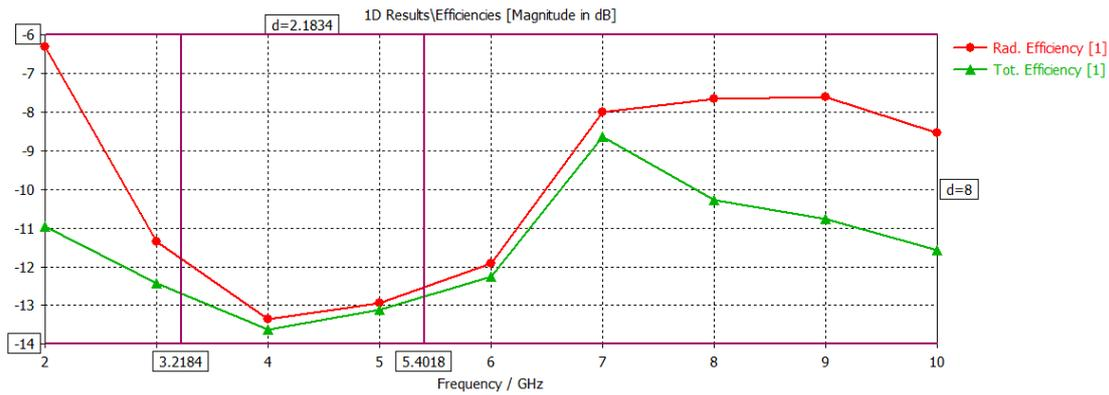
Figura 6.49: Eficiencias de radiación de la ranura con círculos a 3.1 GHz con el modelo de 5 capas de tejido
