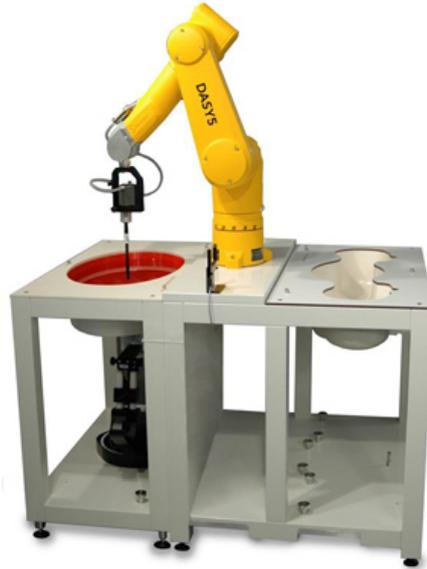
Figura 2.12: Ejemplo de phantom líquido usado principalmente en medidas de SAR [24]
