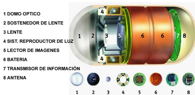
Figura 2.5: Cápsula endoscópica [12]
