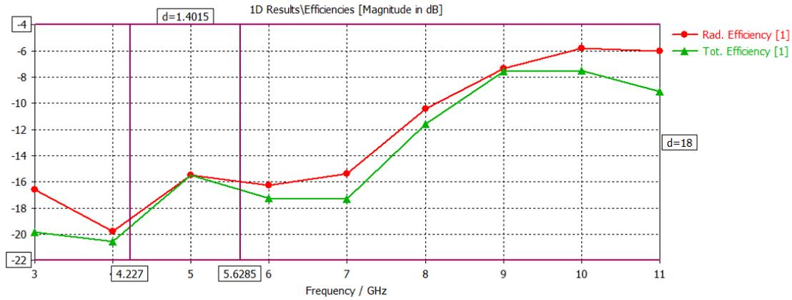
Figura 6.14: Eficiencias de la ranura rectangular con el modelo de 1 capa de tejido
