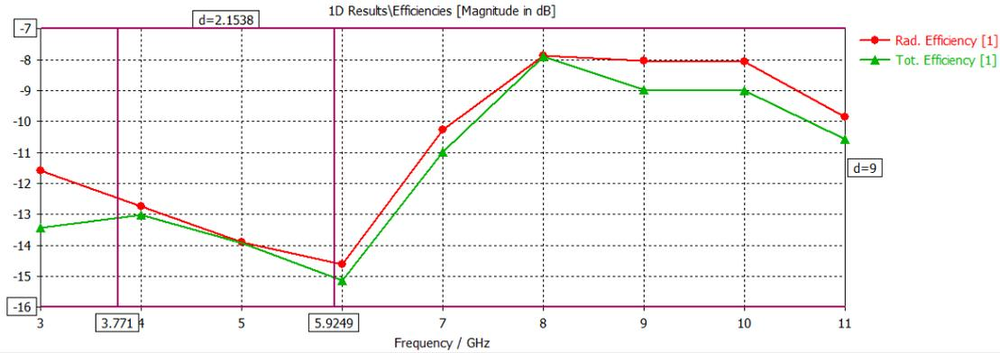
Figura 6.37: Eficiencias de radiación de la ranura con círculos con el modelo de 5 capas de tejido
