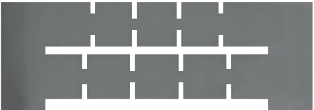
Figura 5.22: Visualización en planta del filtro dual-band N3-N3.
